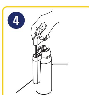
Stecken Sie den Schaumstoffapplikator mit der weißen Kunststoffkappe in den Kanisterschutz. Halten Sie den Behälter aufrecht und drücken Sie die weiße Plastikkappe 3-5 Sekunden lang bis zum Anschlag nach unten. Sie werden nun ein zischendes Geräusch vernehmen. **Achten Sie darauf, dass keine Flüssigkeit mit Ihrer Haut in Berührung kommt!**
